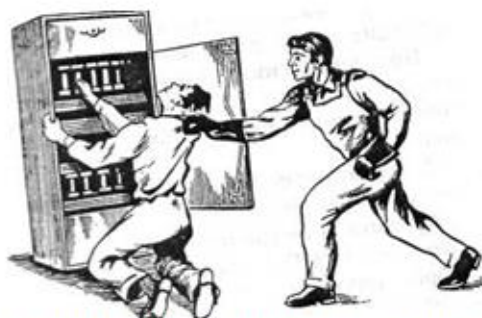
Рис. 4. Освобождение пострадавшего от токоведущей электрического тока
