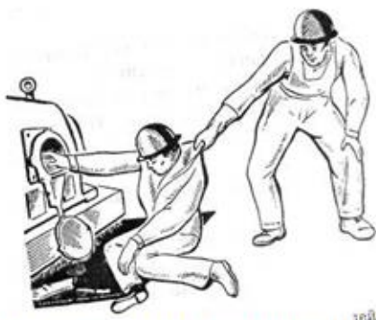
Рис. 3. Освобождение пострадавшего от действия части, находящейся под напряжением до 1000 В
